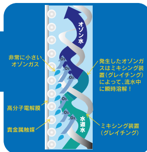
■ スパイラルコア 電極面に水を効率良く供給します
